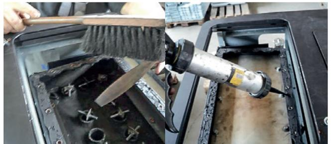
... und reinigen Sie sie einen nach dem anderen. Der Zusammenbau geht umgekehrt vonstatten. Die Silikondichtungen sollten regelmäßig mit thermofestem Silikon erneuert werden!
