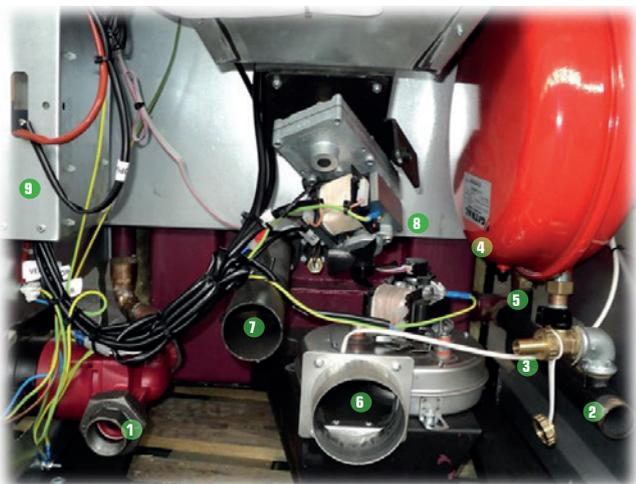
Offene Rückseite mit den Aggregaten: 1. Vorlauf, 2. Rücklauf, 3. Füll-/Ablasshahn, 4. Ausgleichsgefäß, 5. Sicherheitsarmatur 2,5 Bar, 6. Saugzuggebläse und Rauchrohranschluss Ø 80 mm, 7. Zuluft Ø 50 mm, 8. Schneckenantrieb (Dosator), 9. Hauptplatine und Steuereinheit
