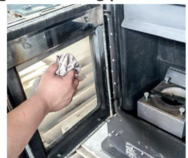
Die **Dichtung der Tür** muss auf Ihren Sitz und Ihre Dichtheit regelmäßig überprüft und eventuell gewechselt werden, da eine geregelte Primärluftzuführung (keine „Falschluff“) für einen einwandfreien Betrieb und die Abgaswerte des Ofens sehr wichtig ist. Gleichzeitig muss sichergestellt sein, dass keine giftigen Gase in den Aufstellungsort austreten können.
