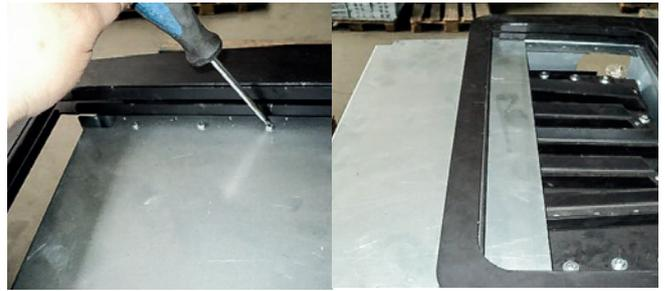
■ Sie finden eine verzinkte Abdeckplatte mit Schrauben gesichert. Entfernen Sie die Schrauben und ziehen Sie die Platte nach vorne heraus.
