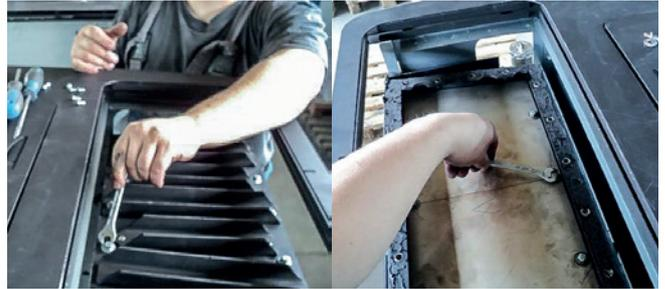
■ Nun schrauben Sie den Luftwärmetauscher ab, ebenso die Turbulatoren-Abdeckplatte
