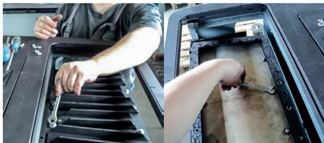
■ Nun schrauben Sie den Luftwärmetauscher ab, ebenso die Turbulatoren-Abdeckplatte
