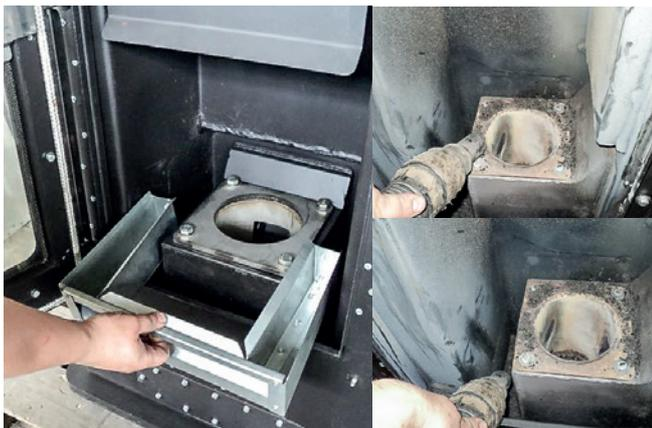
■ Säubern Sie den Sitz des Brenners und nach **Entnahme des Aschenbehälters** den Raum rund um den Brenner. Befreien Sie auch im Brennersitz pedantisch den **Zwischenraum zwischen Zündstab (1)** und seinem **Schutzmantel (2)** von Staub und Asche [beachten Sie dazu die Skizze rechts] Die Lebensdauer des Zünders wird so bedeutend erhöht.
