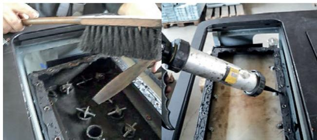
... und reinigen Sie sie einen nach dem anderen. Der Zusammenbau geht umgekehrt vonstatten. Die Silikondichtungen sollten regelmäßig mit thermofestem Silikon erneuert werden!
