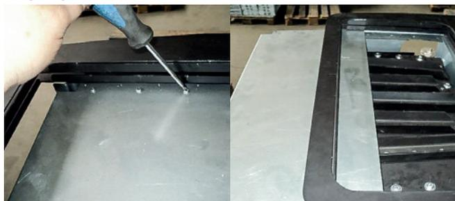
■ Sie finden eine verzinkte Abdeckplatte mit Schrauben gesichert. Entfernen Sie die Schrauben und ziehen Sie die Platte nach vorne heraus.
