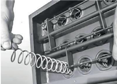
Eine Spindel kann seitlich aus dem Gehäuse entnommen werden.
