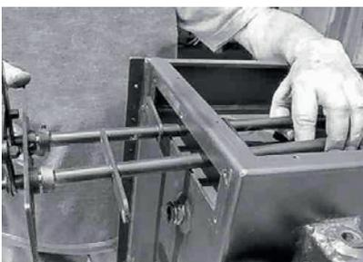
Mit einer geeigneten Bürste reinigen Sie bitte die Wärmetauscher-Röhren so gründlich wie möglich.
