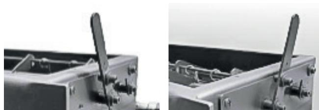
Ofen ohne Verkleidung, Hebel für Wärmetauscherreinigung
