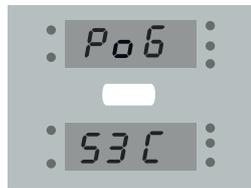
**Leistungsstufe** des Ofens (zB. „Po6“) und die **Raumtemperatur** angezeigt (zB. „15 C“). Im unteren Display wird die **Temperatur des Heizwassers** angezeigt (zB. „53 C“)
