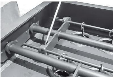
Lösen Sie die Schrauben, welche die Turbulatorenmechanik festhalten
