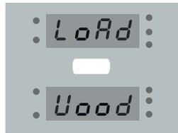
In der Phase „LoAd Wood“ befördert die Schnecke Pellets in die Brennerschale, bis sie in etwa zur Zünderöffnung gefüllt ist (beim Erstbetrieb bitte überprüfen, ob die Öffnung mit Pellets bedeckt ist), nach einem durch den Service festgelegten Intervall zündet der Ofen.
