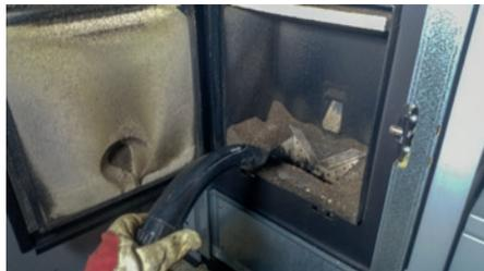
**Bei erkaltem Ofen:** Öffnen Sie die vordere Tür des Kessels und auch die **Brennraumtür**, der Brenner mit der automatischen Entschungsanlage liegt vor Ihnen. Mit einem geeigneten Aschesauger **säubern Sie den Brennraum von allem losen Material**, besonders aber die Öffnung des Zünders mittig im unteren Bereich des Brenner liegend. Ent-
