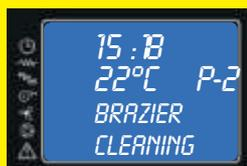
Im Technischen Menü festgelegten Intervallen wird die Anzeige wechseln: Am Display erscheint **REINIGUNG/BRAZIER CLEANING** die Brennerschale wird mit maximaler Lüfterdrehzahl von Staub und Aschenresten ausgeblasen, die Pelletdosierung wechselt in dieser Zeit auf ein Minimum. Nach einigen Minuten arbeitet der Ofen wieder im Normalmodus.
