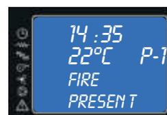
Nach 5-18 Minuten sollte die Phase *FEUER AN/FIRE PRESENT* erreicht sein (= Rauchgastemperaturfühler meldet mindestens 50° C). Sollte keine Flamme entstehen, wird es
